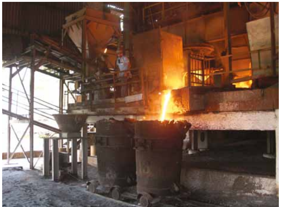
Test ferronickel pour at the Morro Azul RKEF plant.
