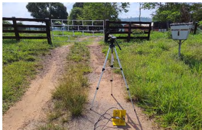
Equipamentos utilizados para o monitoramento de qualidade do ar (à esquerda) e equipamento utilizado para a medição de ruído (à direita).
