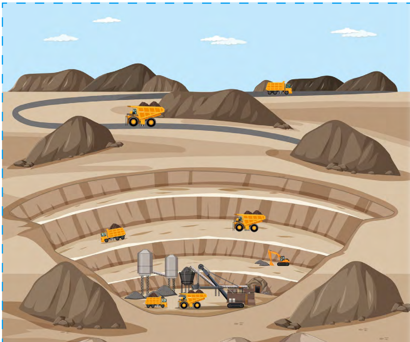
Desenho esquemático da lavra a céu aberto do tipo bancadas.
